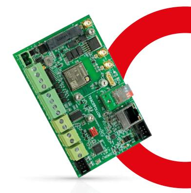
Il pannello Trace&Follow è in grado di inviare i dati acquisiti dalla piattaforma Cloud utilizzando diverse opzioni di connettività: WiFi, Ethernet, LTE, LoRaWAN (per lunghe distanze con un singolo gateway).
